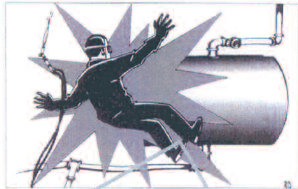
Figure 1 : explosion due à un dégazage incomplet
